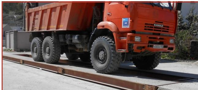
**Динамический режим взвешивания** — это режим взвешивания «в движении»: транспортное средство заезжает на весы, и, не останавливаясь, проезжает по ним. ПО фиксирует изменение веса, обнаруживает участки, соответствующие заезду или проезду осей ТС, вычисляет соответствующий вес и автоматически его фиксирует. Таким образом, динамический режим взвешивания — это один из автоматических режимов работы ПО.
