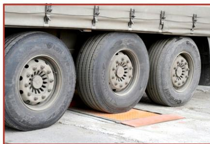
При ручном режиме взвешивания - взвешивание всегда статическое. В автоматическом режиме - режим взвешивания задаётся файлом сценария.
