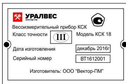
Рисунок 1 – Общий вид маркировочной таблички
