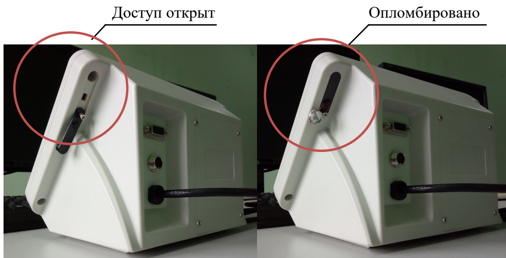
Рисунок 2 – Схема пломбировки от несанкционированного доступа
