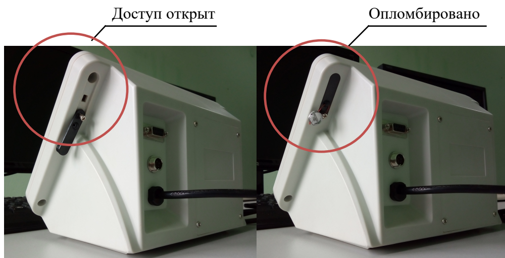
Рисунок 2 – Схема пломбировки от несанкционированного доступа
