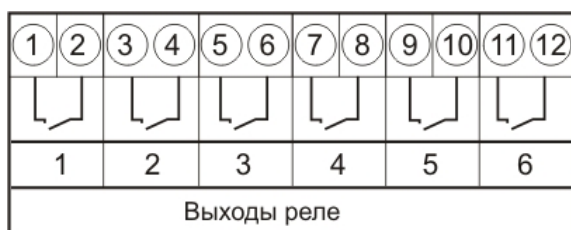
Рисунок А.4 Разъём релейных выходов
