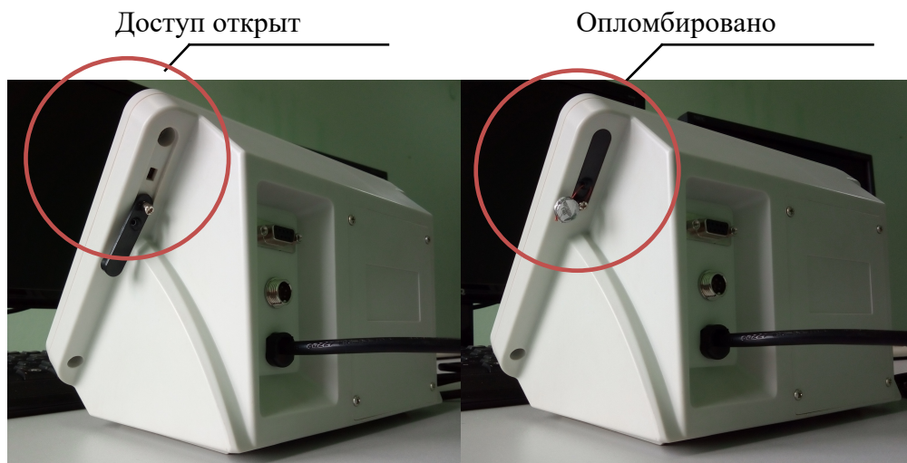
Рисунок 2 – Схема пломбировки от несанкционированного доступа
