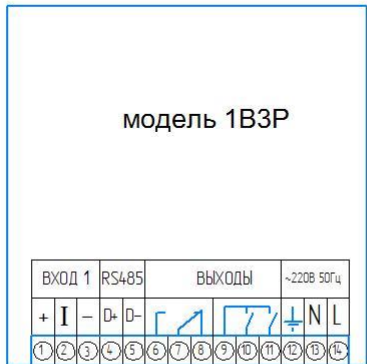
Схема расположения и состав выходов ИСД342
