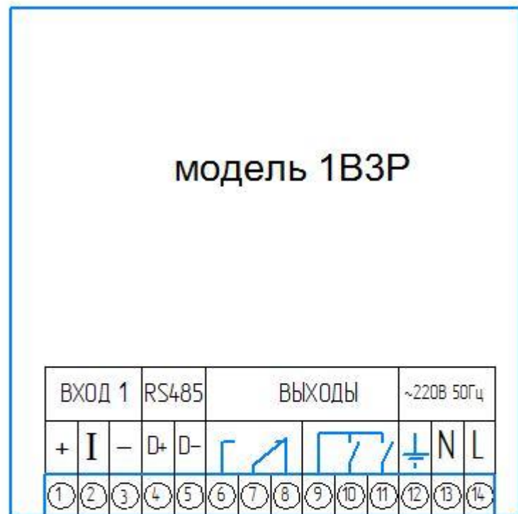
Схема расположения и состав выходов ИСД342
