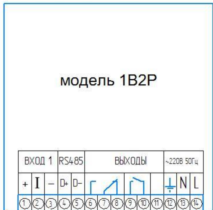
Схема расположения и состав выходов ИСД332
