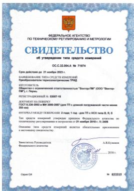
Термопары ТРИД предназначены для измерения температуры жидкого, газо- и парообразных сред, в системах технологического управления и контроля, в различных отраслях промышленности, коммунального и сельского хозяйства. Выпускаются по ГОСТ 6616-94 и техническим условиям ТУ 4211-011-60694339-2018. Внесены в Государственный реестр средств измерений за номером № 53007-18, сертификат ОС.С.32.004.А № 71974 от 21.11.2018 г.
