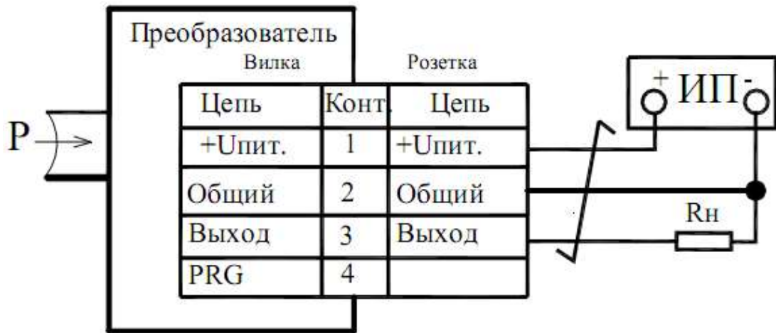
Рисунок Б.1 - Схема подключения преобразователей с разъемами DIN 43650 А и 2RMĐT18Б4Ш5В1В
