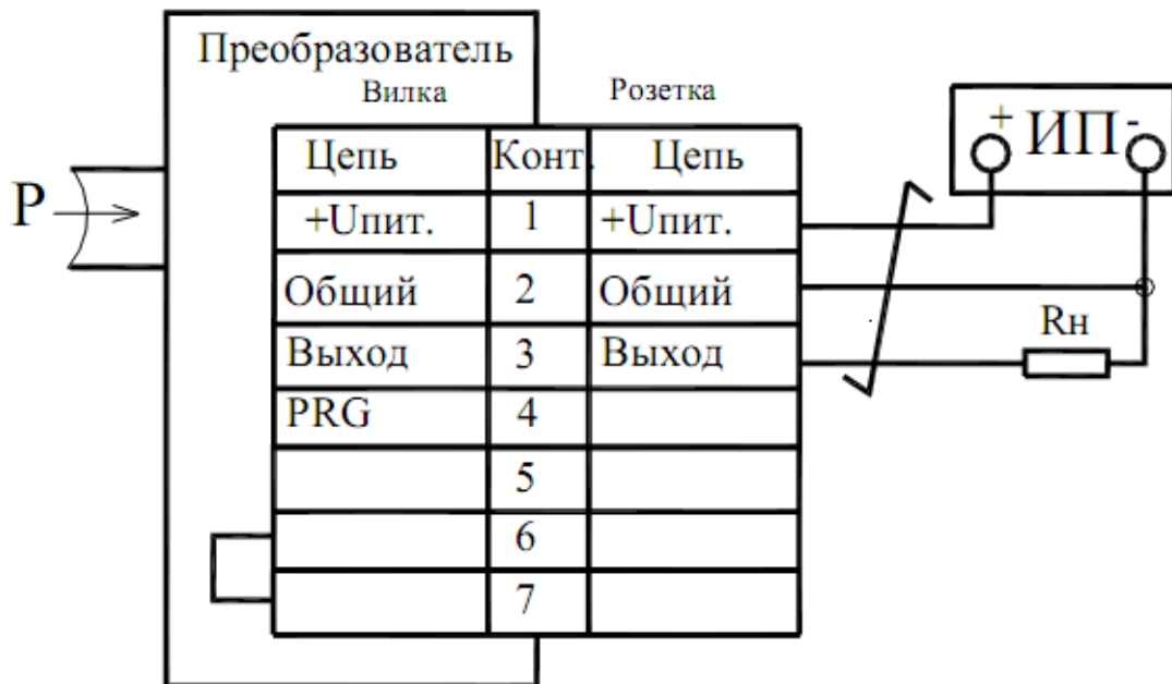
Рисунок Б.2 - Схема подключения преобразователей с разъемом 2RMĐT18Б7Ш1В1В
