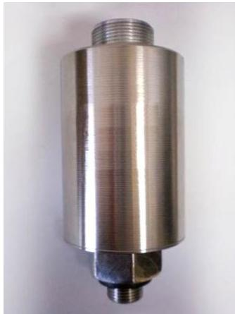
Датчики серии ТРИД-РИР измеряют величину избыточного давления-разрежения жидких и газообразных сред, точкой отсчета является вакуум, а максимальный верхний предел измерения превышает реальное атмосферное давление, при этом ноль находится внутри диапазона измерения и равен атмосферному давлению.
