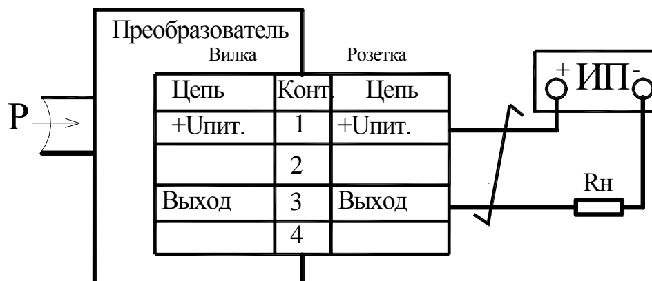
Рисунок Б.1 – Схема подключения преобразователей общепромышленного исполнения с кодом электрического соединителя 10, 13, 60
