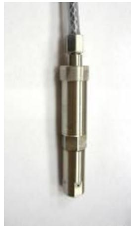
Датчики давления применяются в системах автоматического контроля и управления технологическими процессами в различных отраслях промышленности, в том числе в системах тепло-, газо- и водоснабжения, в компрессорных и гидравлических установках. Принцип действия преобразователей основан на преобразовании давления измеряемой среды, воздействующей на мембрану чувствительного элемента, в электрический сигнал, пропорциональный механической деформации мембранны.
